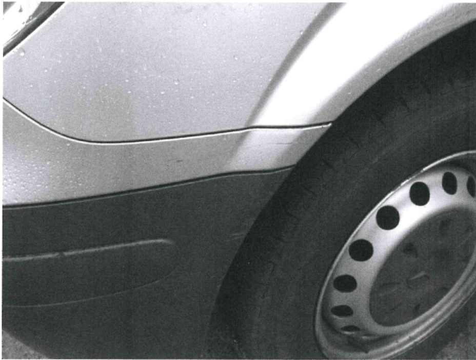
Bild 5 : Frontblende links zerkratzt Stoßfänger vorn links verschrammt
