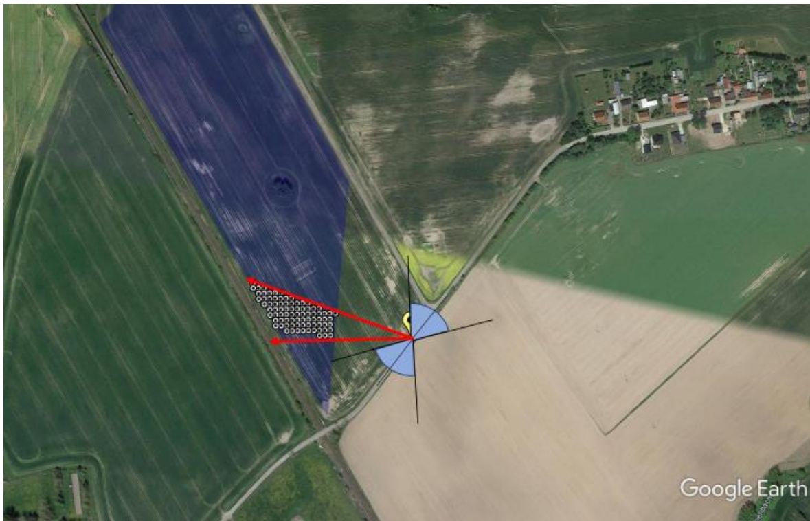
Abbildung 67: Vergleich Sichtfeld Fahrzeugführer zu Punkt B3 (Azimut = 170^\circ ) mit Grenzvektoren in Richtung Module
