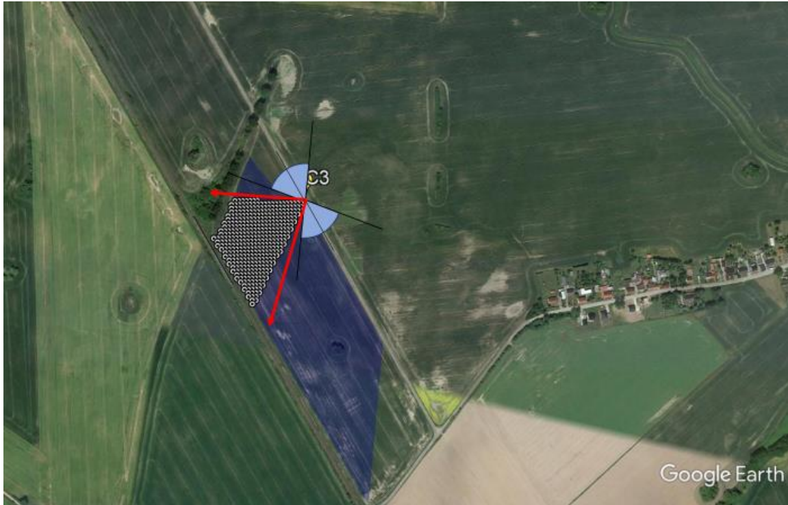
Abbildung 81: Vergleich Sichtfeld Fahrzeugführer zu Punkt C3 (Azimut = 90°) mit Grenzvektoren in Richtung Module
