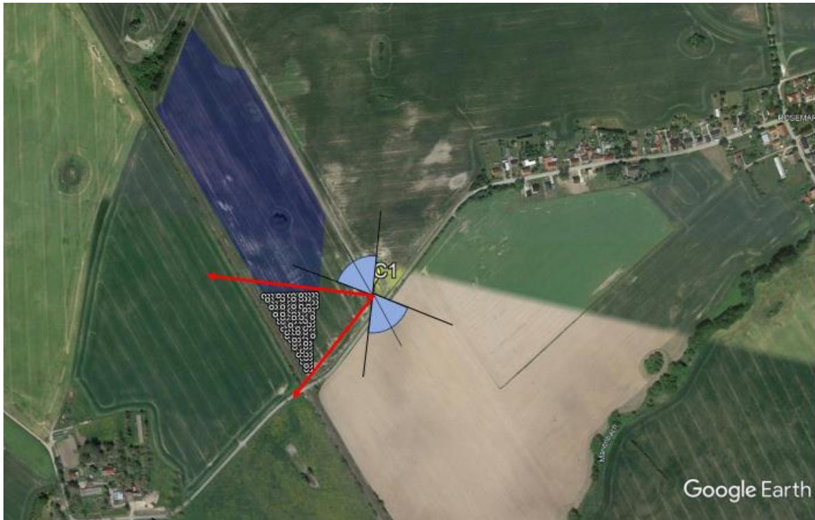
Abbildung 79: Vergleich Sichtfeld Fahrzeugführer zu Punkt C1 (Azimut = 90°) mit Grenzvektoren in Richtung Module
