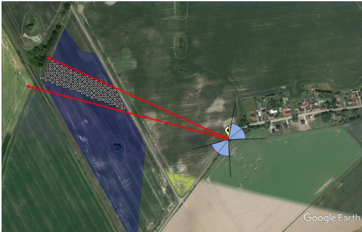
Abbildung 70: Vergleich Sichtfeld Fahrzeugführer zu Punkt B4 (Azimut = 180°) mit Grenzvektoren in Richtung Module
