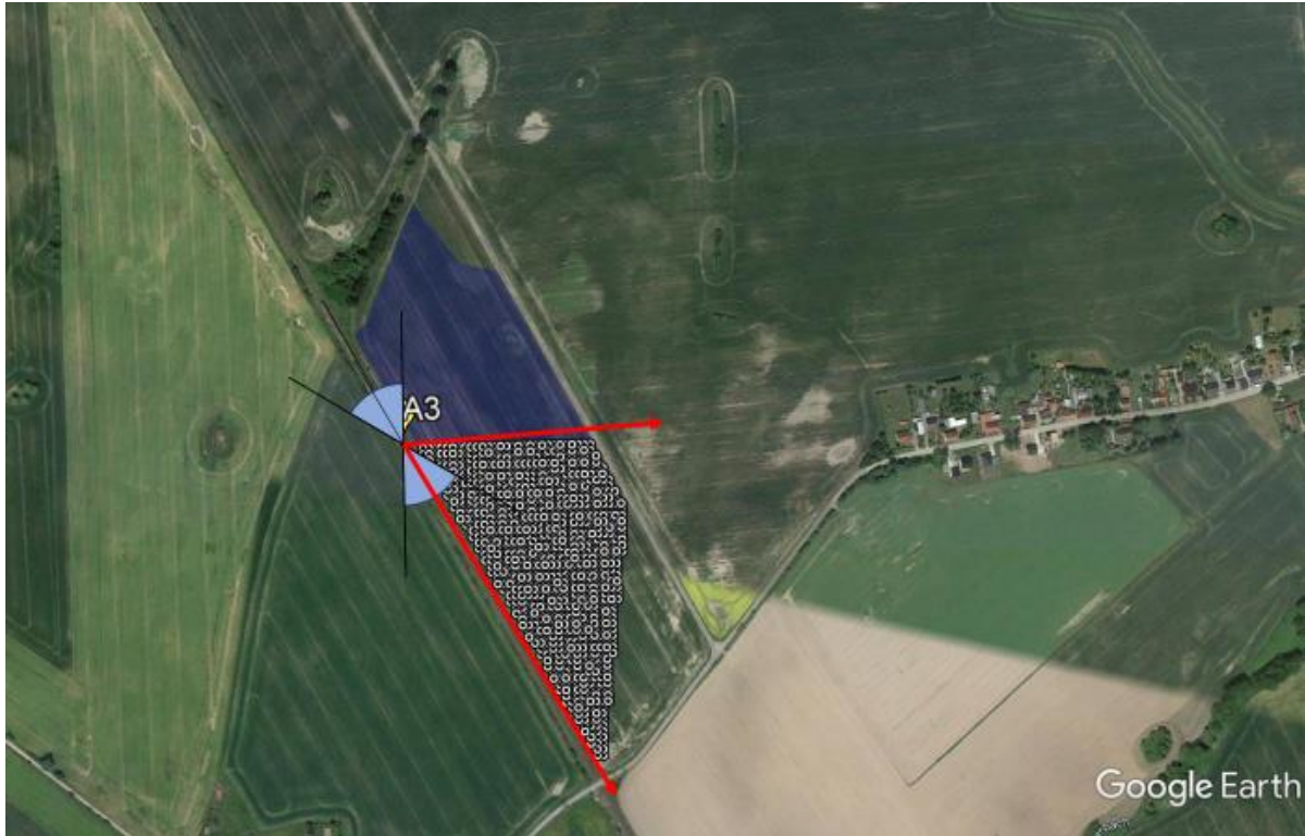
Abbildung 65: Vergleich Sichtfeld Zugführer für Punkt A3 (Azimut = 270^\circ ) mit Grenzvektoren in Richtung Module
