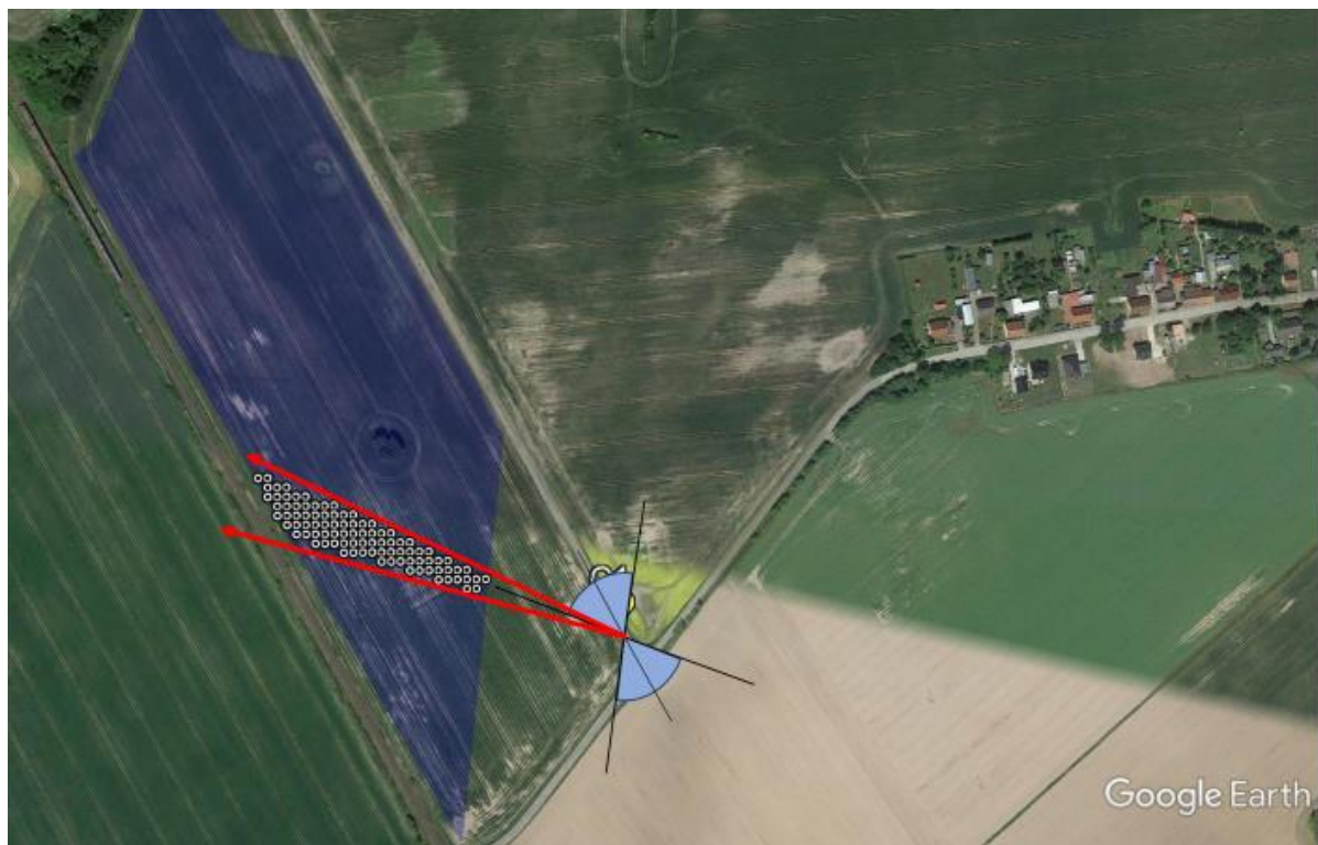
Abbildung 76: Vergleich Sichtfeld Fahrzeugführer zu Punkt C1 (Azimut = 180°) mit Grenzvektoren in Richtung Module
