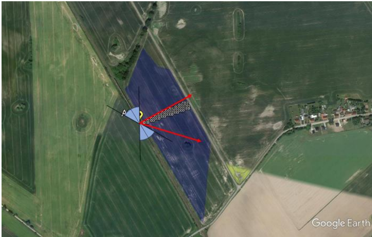
Abbildung 63: Vergleich Sichtfeld Zugführer für Punkt A3 (Azimut = 180^\circ ) mit Grenzvektoren in Richtung Module
