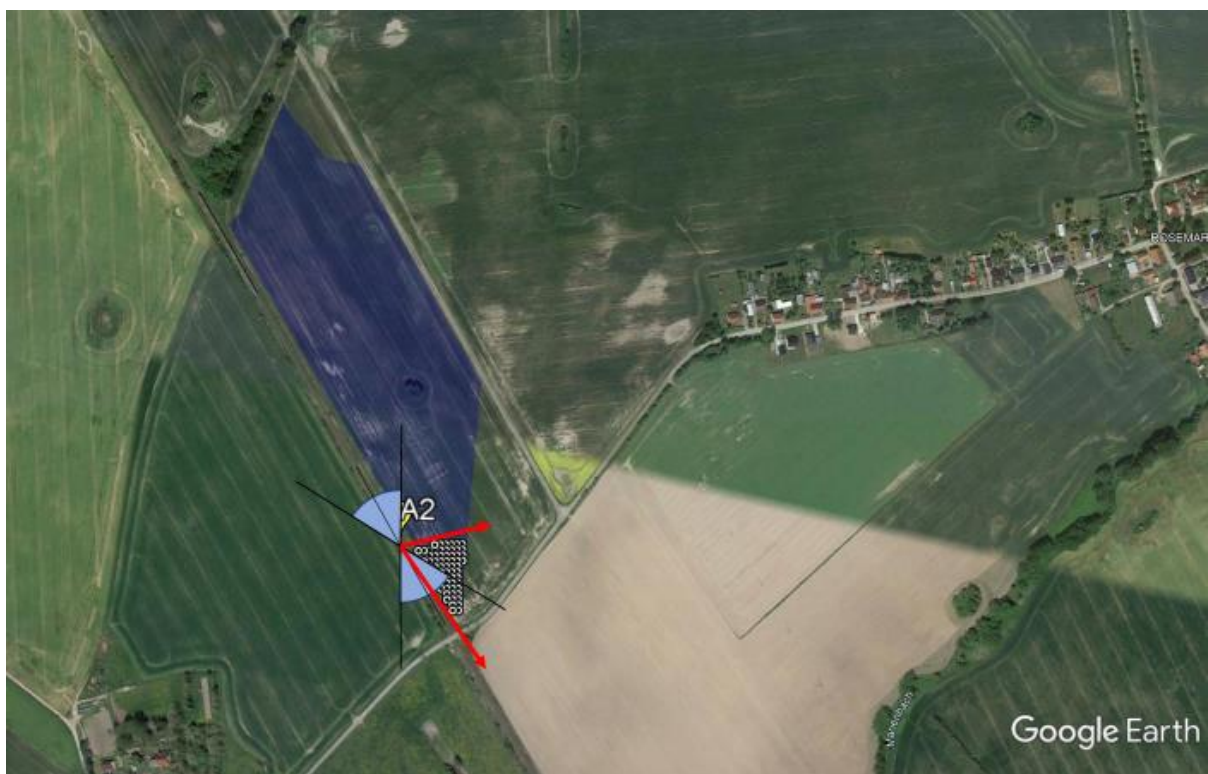
Abbildung 64: Vergleich Sichtfeld Zugführer für Punkt A2 (Azimut = 270^\circ ) mit Grenzvektoren in Richtung Module
