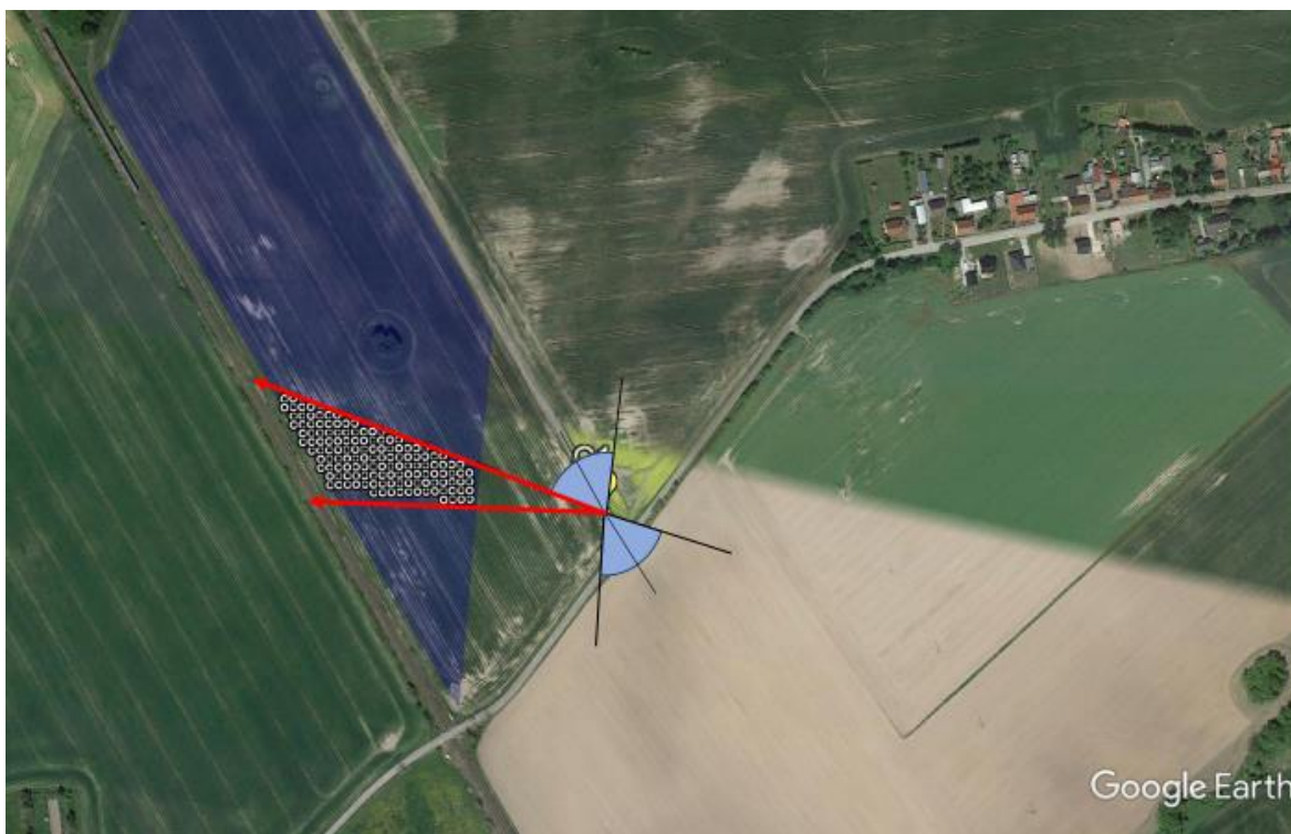
Abbildung 73: Vergleich Sichtfeld Fahrzeugführer zu Punkt C1 (Azimut = 170°) mit Grenzvektoren in Richtung Module
