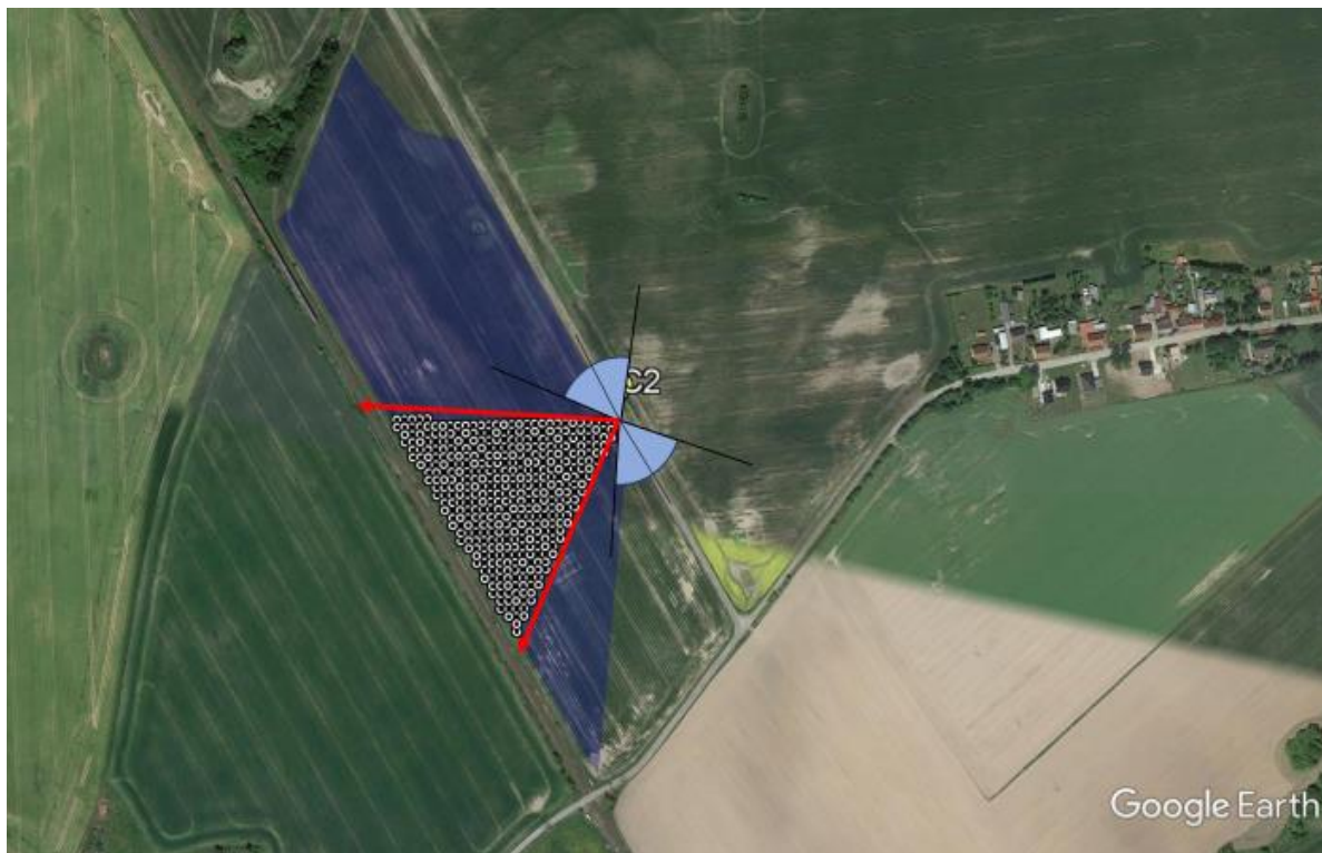
Abbildung 80: Vergleich Sichtfeld Fahrzeugführer zu Punkt C2 (Azimut = 90°) mit Grenzvektoren in Richtung Module
