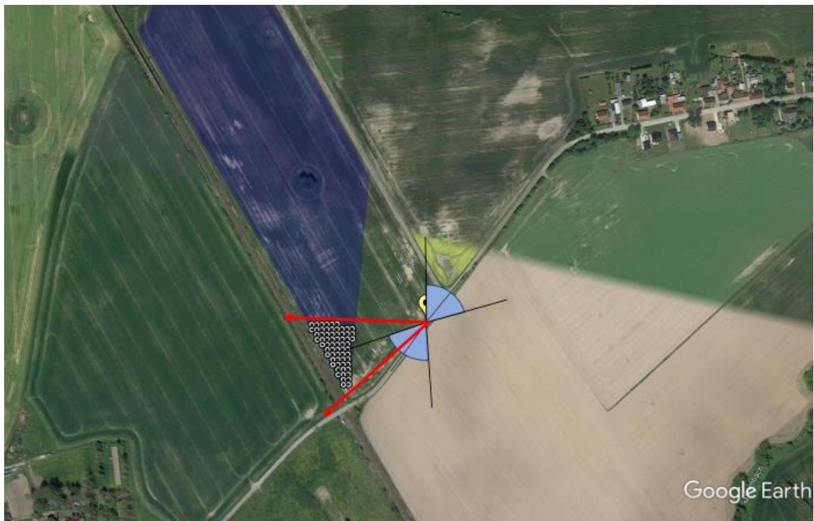
Abbildung 71: Vergleich Sichtfeld Fahrzeugführer zu Punkt B3 (Azimut = 90°) mit Grenzvektoren in Richtung Module
