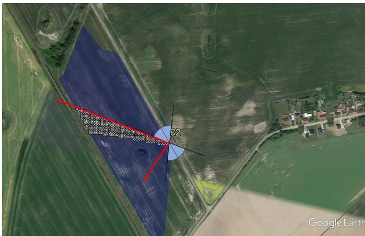
Abbildung 74: Vergleich Sichtfeld Fahrzeugführer zu Punkt C2 (Azimut = 170°) mit Grenzvektoren in Richtung Module
