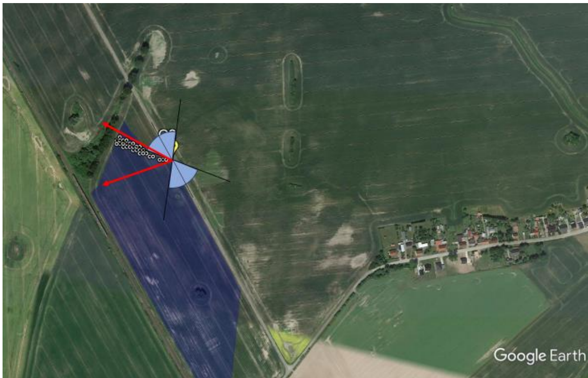
Abbildung 78: Vergleich Sichtfeld Fahrzeugführer zu Punkt C3 (Azimut = 180^\circ ) mit Grenzvektoren in Richtung Module
