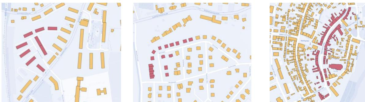
Abbildung 17: Verbrauchsstellen für die Validierung des Wärmebedarfsmodells (links: "Straße der Zukunft" (Fernwärme), Mitte: „Ahornweg 1-18“ (Erdgas) und rechts: „Oberbaustraße“ (Erdgas); rot markierte Gebäude zählen zu den aufsummierten Verbrauchsstellen
