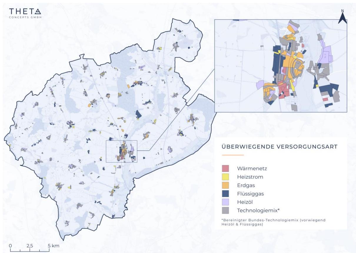
Abbildung 19: Überwiegende Wärmeversorgungsart in den Baublöcken im Ausgangsjahr
