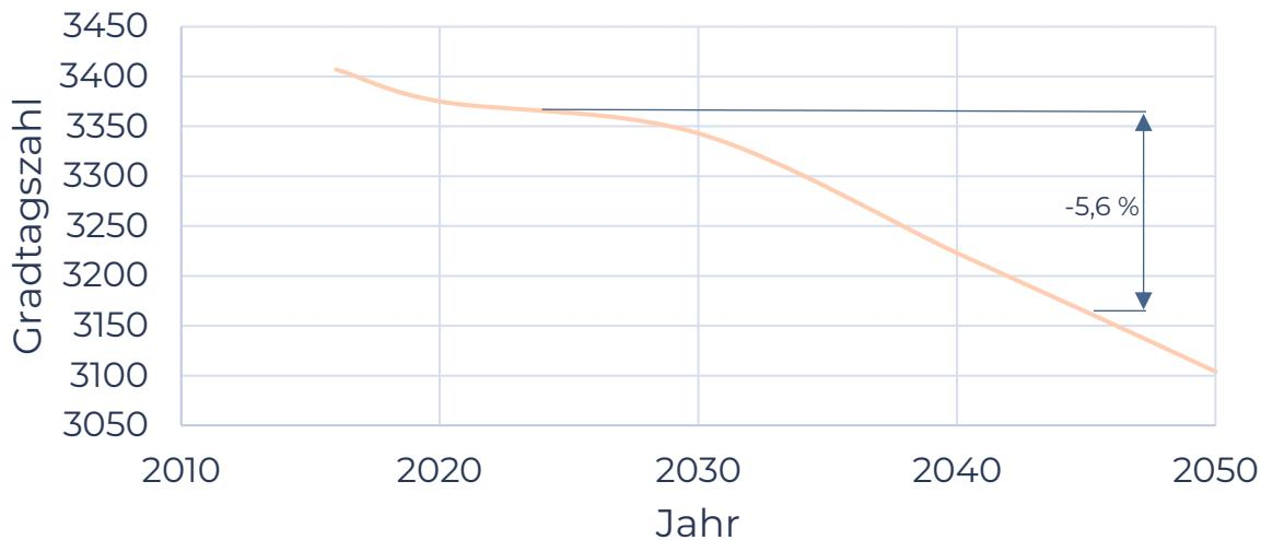
Abbildung 27: Entwicklung der Gradtagzahlen als exogener Einfluss auf Wärmebedarfsprognose;
