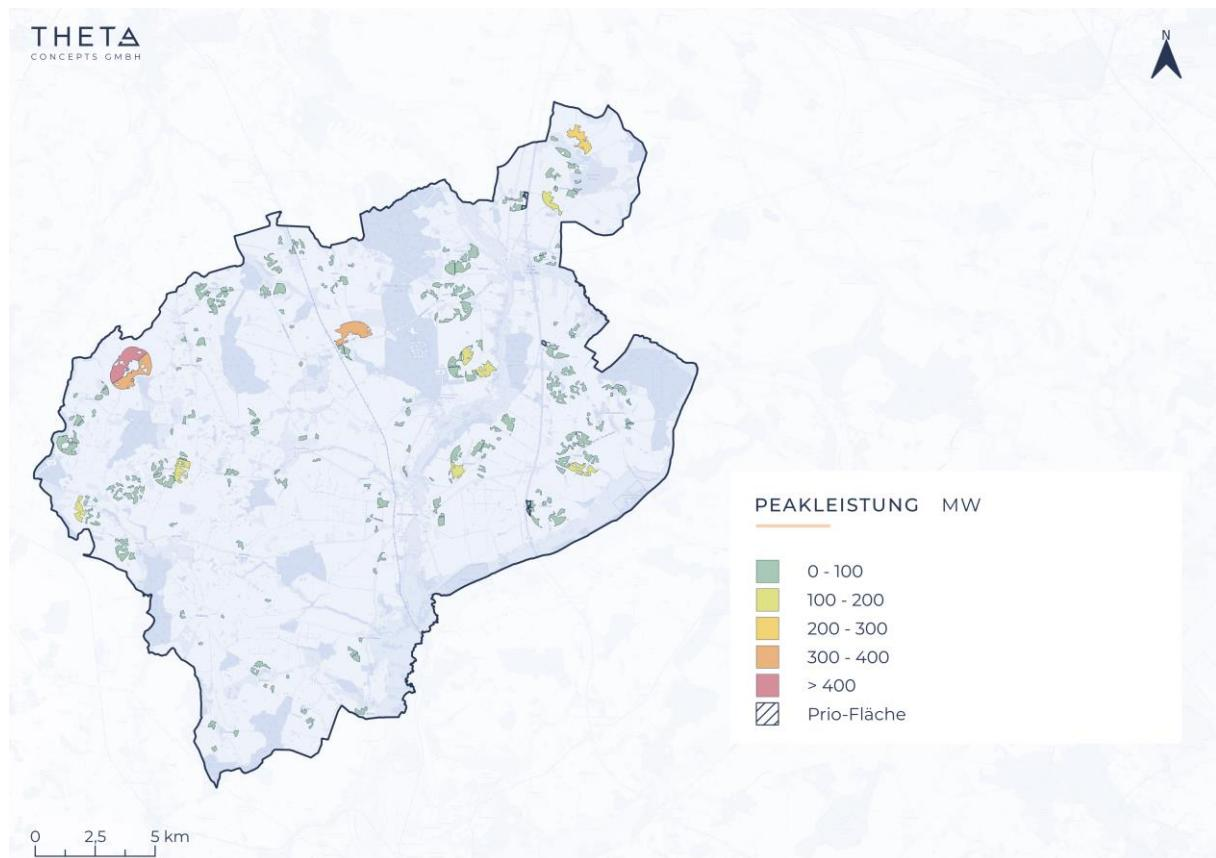
Abbildung 34: Potenziale von Freiflächen-Solarthermie unter Annahme von Flachkollektoren
