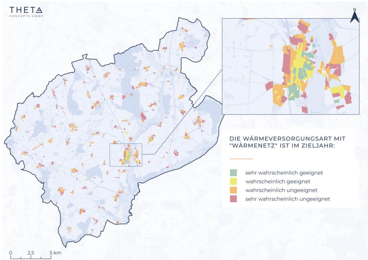
Abbildung 47: Eignung für Wärmenetze im Zieljahr 2045
