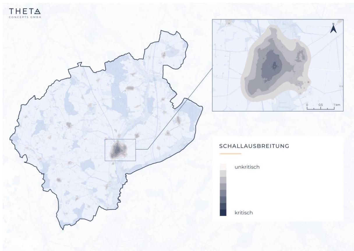
Abbildung 41: Qualitative Schallindikation durch flächendeckenden Einsatz von Luftwärmepumpen
