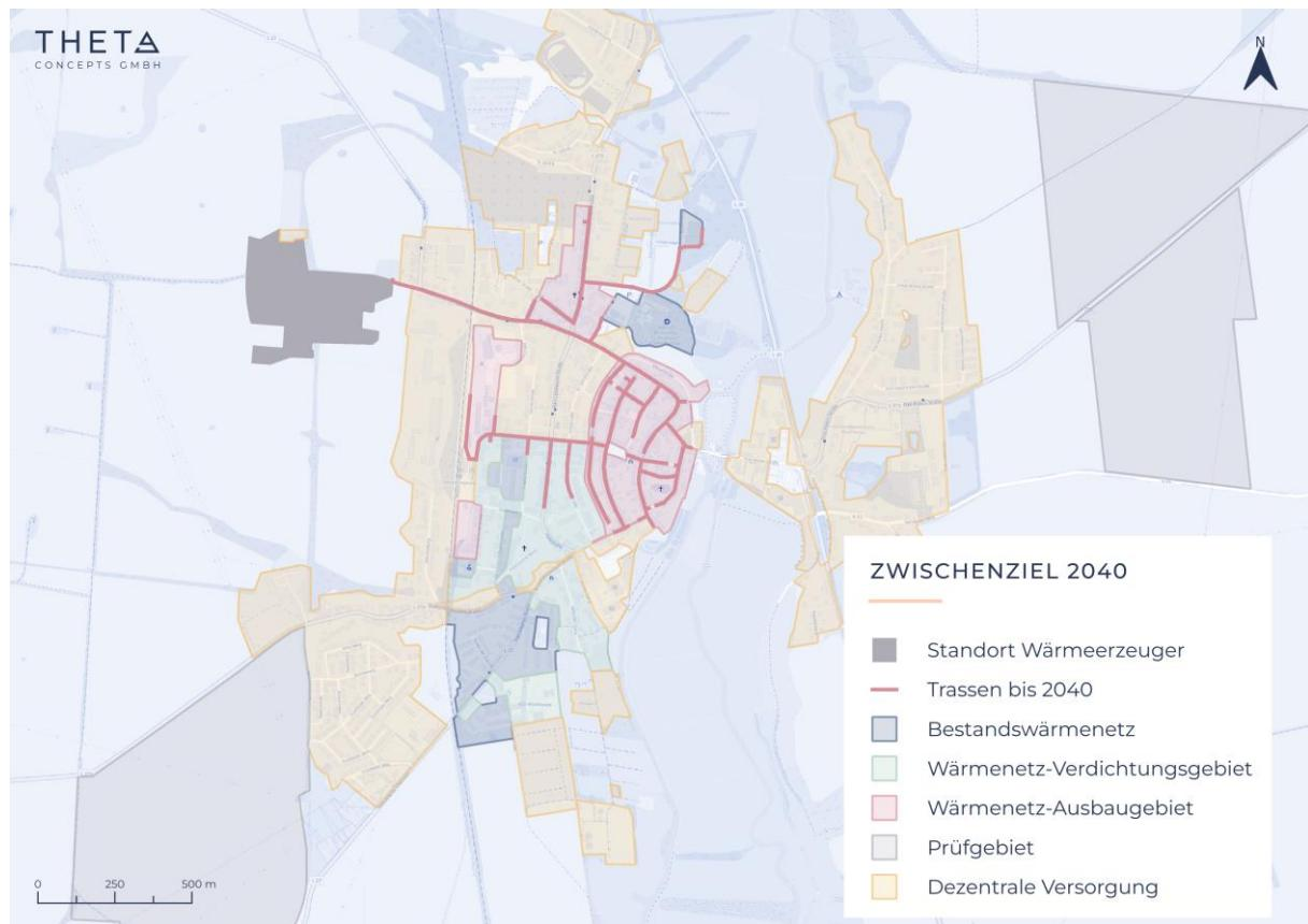
Abbildung 54: Zwischenziel Fernwärmearausbau Altentreptow bis 2040
