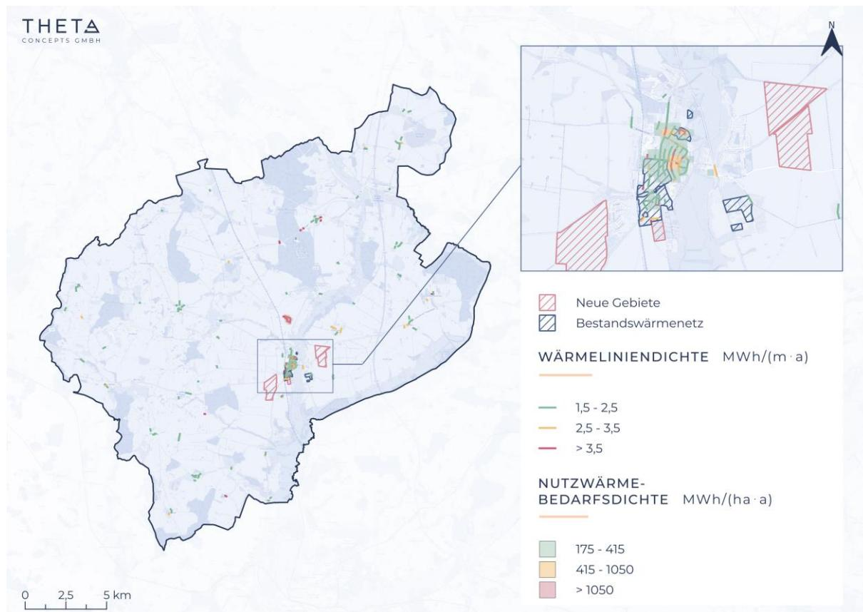
Abbildung 46: Wärmebedarfs- und Wärmeliniendichte im Zieljahr 2045 zur Bewertung der Eignung von Fernwärme
