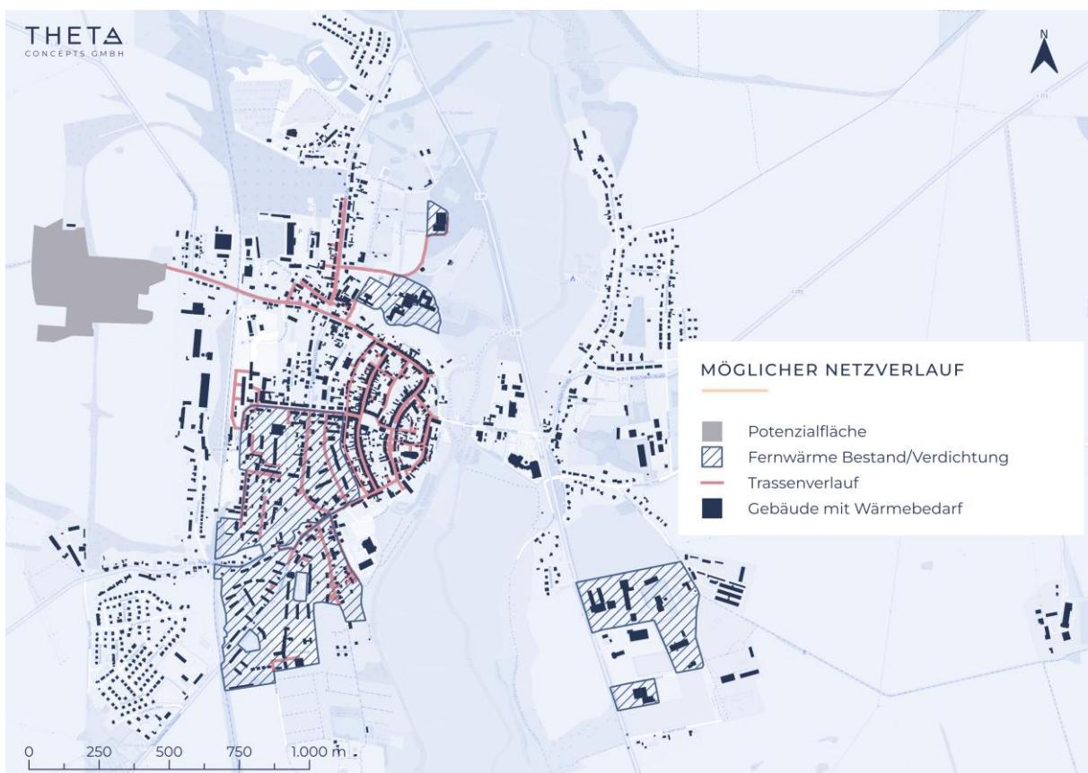
Abbildung 49: Entwurf des Altentreptower Fernwärmennetzausbau und Anschlusses an die Potenzialfläche für das Zielszenario 2045 (Bestehende Infrastruktur beliefert ausgehend vom neuen Technologiestandort den Osten der Stadt, entsprechende Trassen sind nicht eingezeichnet.)
