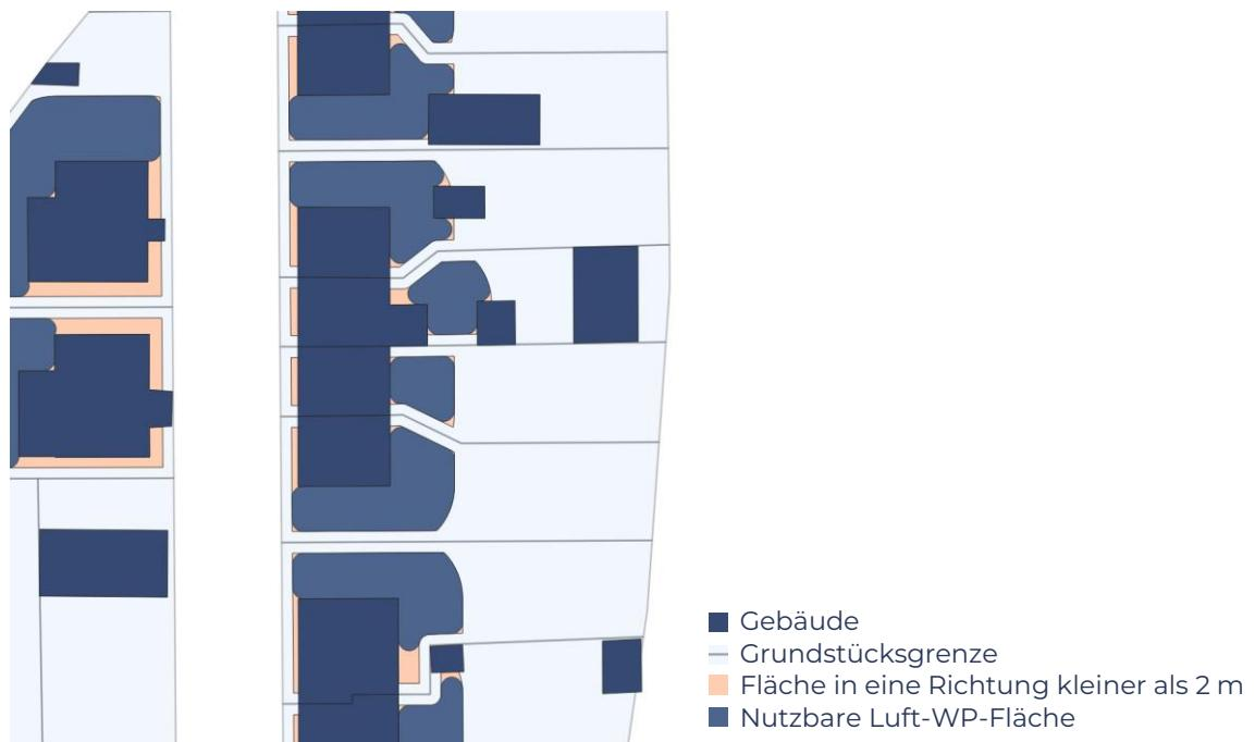
Abbildung 39: Datengetriebene Methode zur Eignungsprüfung von Luftwärmepumpen für sämtliche zu beheizende Gebäude im Planungsgebiet auf Basis verfügbarer Flächen und Heizlasten
