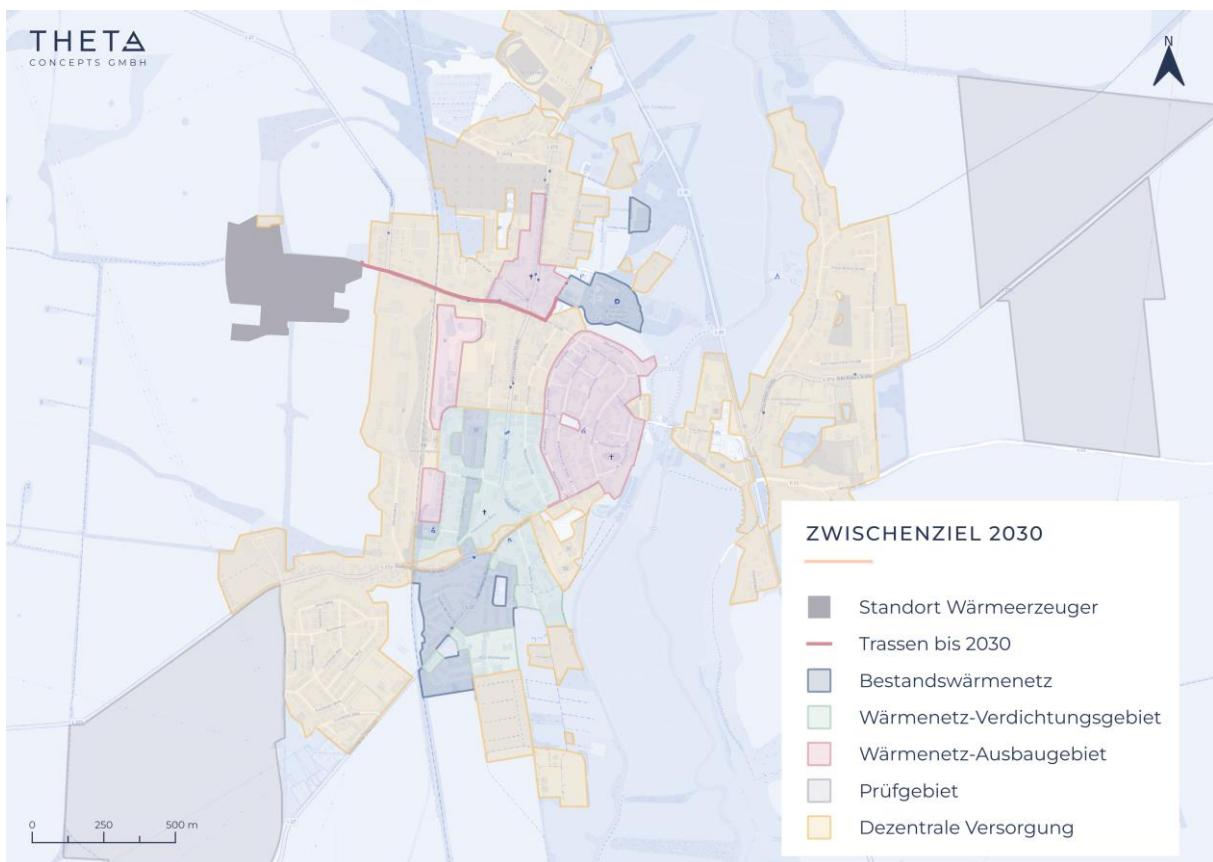
Abbildung 52: Zwischenziel Fernwärmearausbau Altentreptow bis 2030
