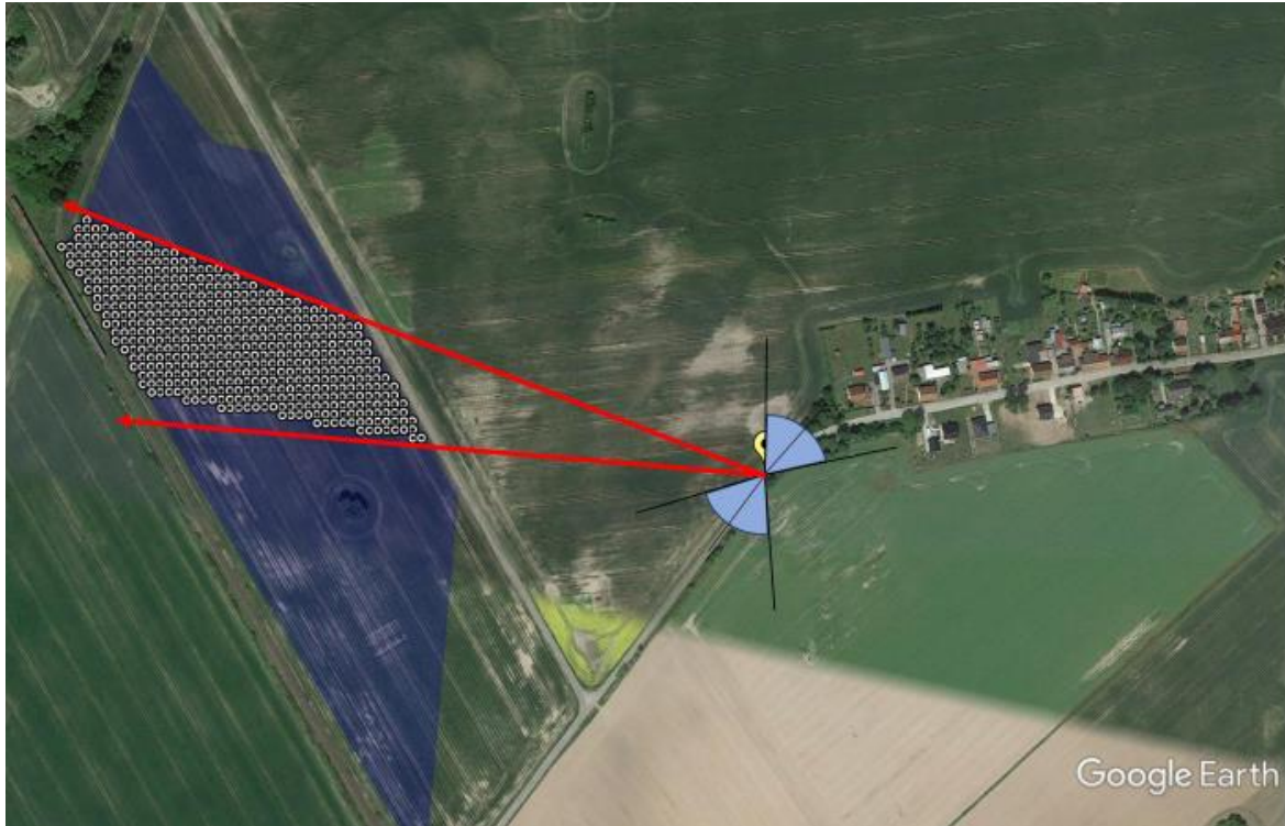
Abbildung 68: Vergleich Sichtfeld Fahrzeugführer zu Punkt B4 (Azimut = 170^\circ ) mit Grenzvektoren in Richtung Module
