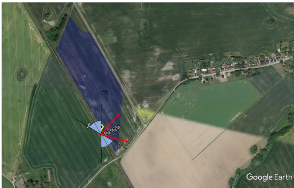
Abbildung 62: Vergleich Sichtfeld Zugführer für Punkt A2 (Azimut = 180°) mit Grenzvektoren in Richtung Module
