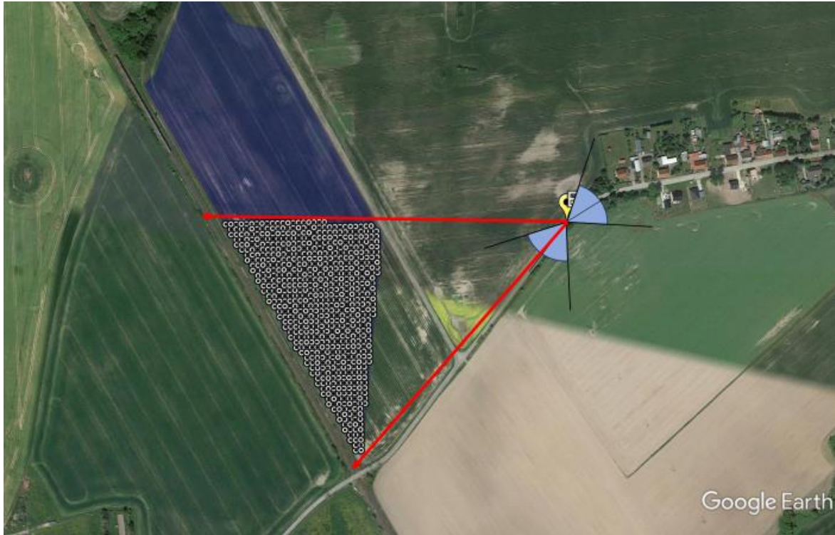
Abbildung 72: Vergleich Sichtfeld Fahrzeugführer zu Punkt B4 (Azimut \approx 90^\circ ) mit Grenzvektoren in Richtung Module
