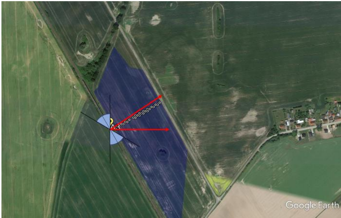
Abbildung 61: Vergleich Sichtfeld Zugführer für Punkt A3 (Azimut = 170°) mit Grenzvektoren in Richtung Module
