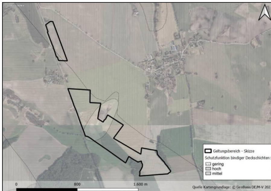
Abbildung 25: Schutzfunktion der Deckschichten zum Schutz des Grundwassers
