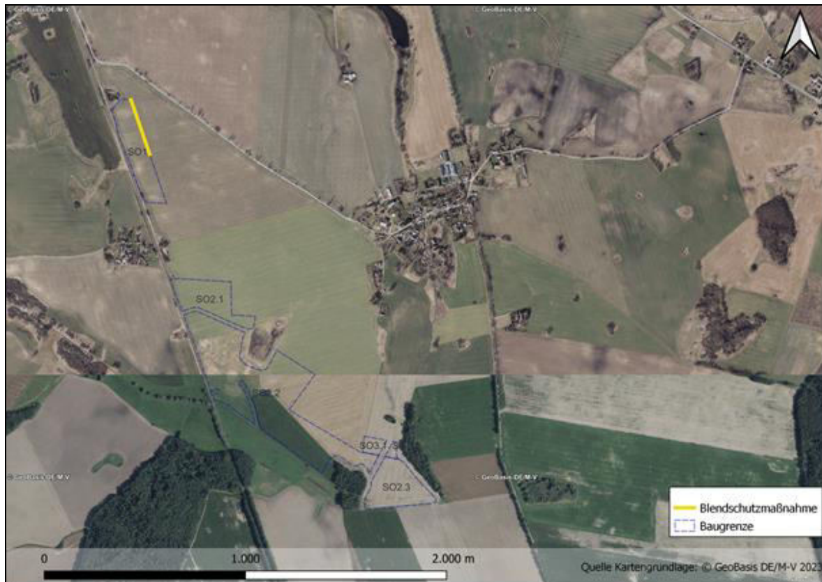
Abbildung 36: Lage der Blendschutz-Maßnahmen bei Südausrichtung der Photovoltaik-Module
