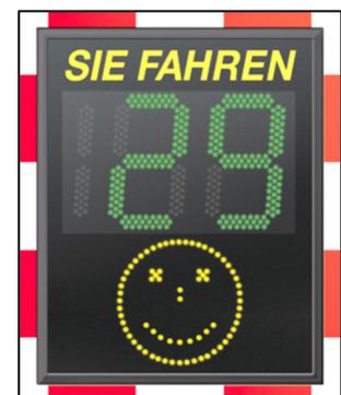
Abbildung 4: Beispiel für mobiles Geschwindigkeitsmessgerät
