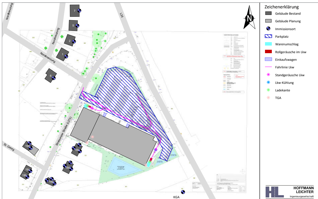
Abbildung 4-1 Lage der Schallquellen zum Anlagenlärm
