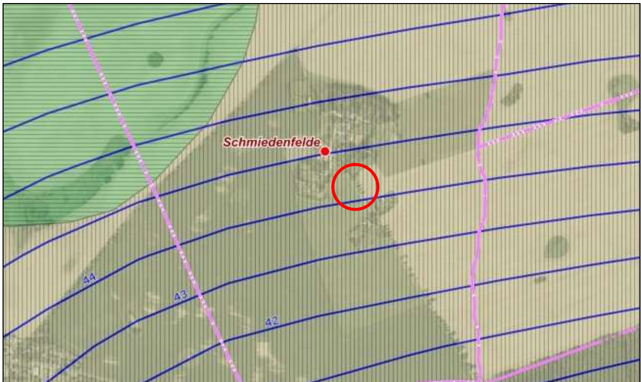
Abbildung 2: Darstellung Grundwasserhöhengleichen, -flurabstand und -überdeckung (Plangebiet rot markiert)
